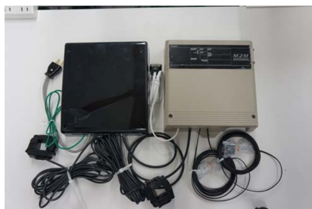
I_{gr} 値測定用アダプタとオムロン製監視装置 (左が I_{gr} 値測定用アダプタ)
